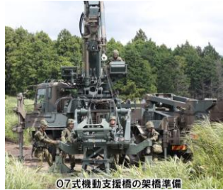
07式機動支援橋の架橋準備
